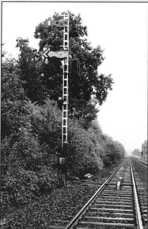
A gauche : signal à palettes à trois positions à l'entrée de la gare de Boussu, encore en service en 1991 A droite : Quiévrain, signal de manoeuvres sur mât, dépourvu de ses lentilles et de l'éclairage (photos Alain Bauwin).
